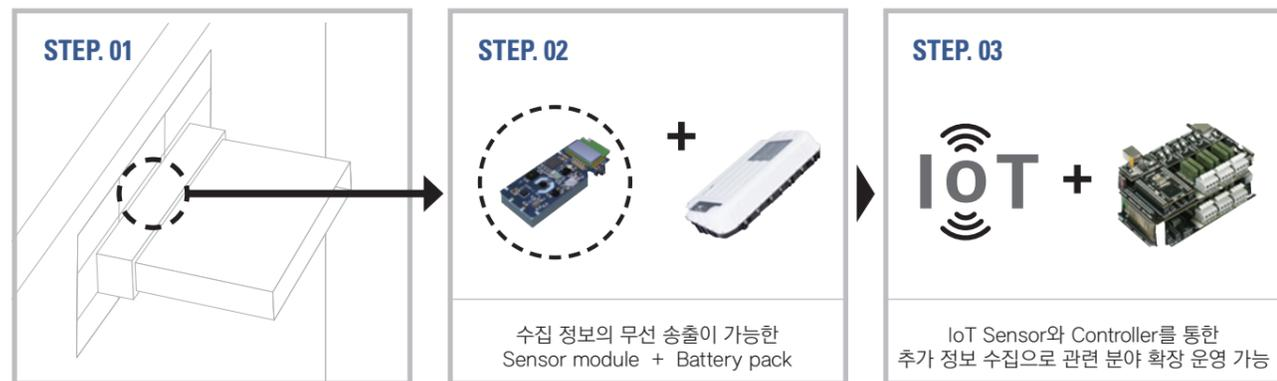
\* 특허 출원 : 관통부 충전용 센서를 이용한, 방화 구획별 개별 실시간 화재 감지가 가능한 건물 모니터링 시스템
